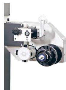
Il **modulo di lavoro** è composto da una morsa rotante con relativo gruppo di frizione e da una testa porta utensile refrigerata che consente di operare sia in modo orizzontale che verticale.
